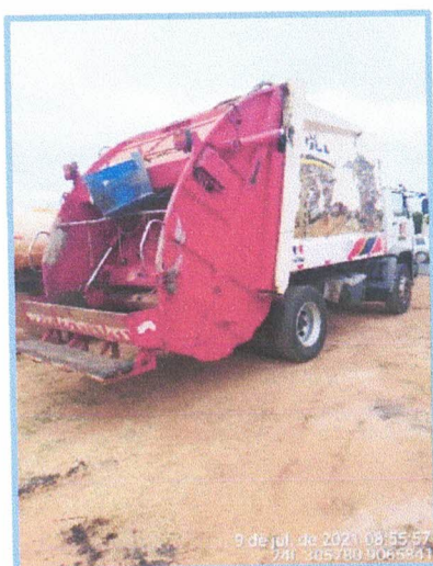
Figura 3-26- Caminhão compactador em serviço
